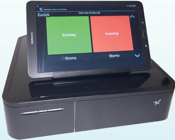
Das System FFS enthält statt der Kasse mit Druckmöglichkeit eine einfache Fahrgastzählfunktion durch große Button Einstieg und Ausstieg. Die Funktionen Fahrerassistenz und Statistik sind analog der FKS-Version.
