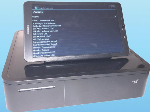
Bei der Zonenkasse wird die Zielhaltestelle angewählt. Das System errechnet den Fahrpreis und zeigt dann nur die entsprechenden Tickets an.
