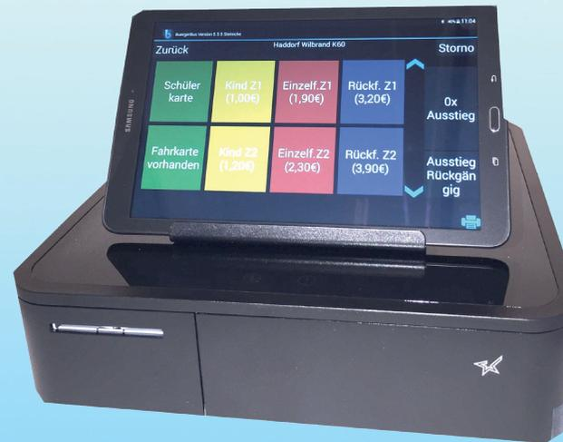
Das Modul **Kasse** unterscheidet sich je nach Version in Standardkasse oder Zonenkasse. In der Standardkasse werden **alle** Ticketarten als Button angezeigt. Bei der Zonenkasse wird durch Auswahl der Zielhaltestelle der Fahrpreis errechnet und dann nur die dafür gültigen Tickets angezeigt. Es können beliebig viele Ticketarten wie Einzel-Rückfahrt- Wochen- oder Monatsticket realisiert werden. Ein Ticketdruck auf Thermopapier ist mit
