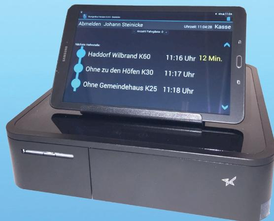
Im **Fahrerassistenz** werden die drei nächsten Haltestellen mit den entsprechenden Abfahrtszeiten sowie der aktuellen Zeitdifferenz bis zur nächsten Haltestelle angezeigt. Wird eine Haltestelle über GPS erkannt, öffnet sich das Haltestellensymbol und beim Verlassen der Haltestelle werden automatisch die nächsten Haltestellen angezeigt.
